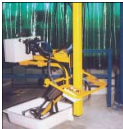
Préhenseur à ventouses à guidage vertical rigide pour bacs de douche en céramique, 50 kg
