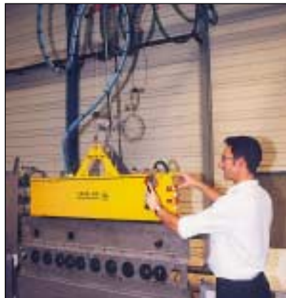
Préhenseur à ventouses pour manteaux de relais thermiques, 45 kg
