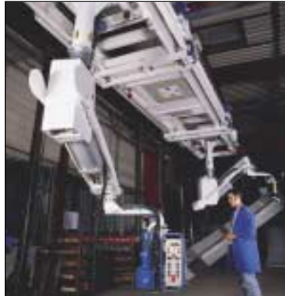
Pince pour pièces d'avion en alliage d'aluminium, 250 kg
