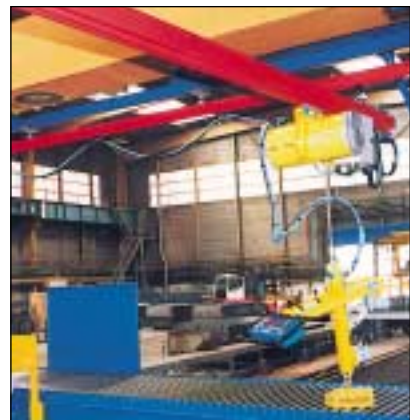
Electro-aimant pour tôles découpées, 100 kg
