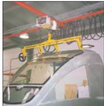
Préhenseur à ventouses pour pare-brise de train, 60 kg
