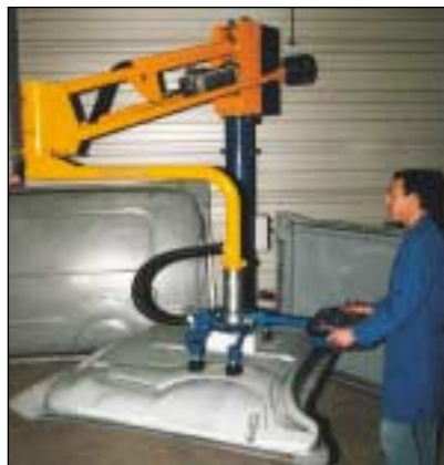
Préhenseur à ventouses pour portes de voitures, 80 kg
