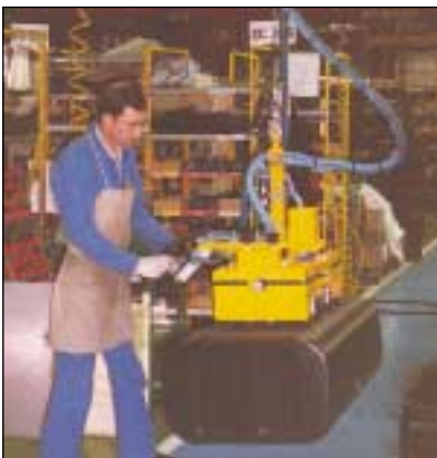
Préhenseur à ventouses pour réservoirs de camions, 85 kg
